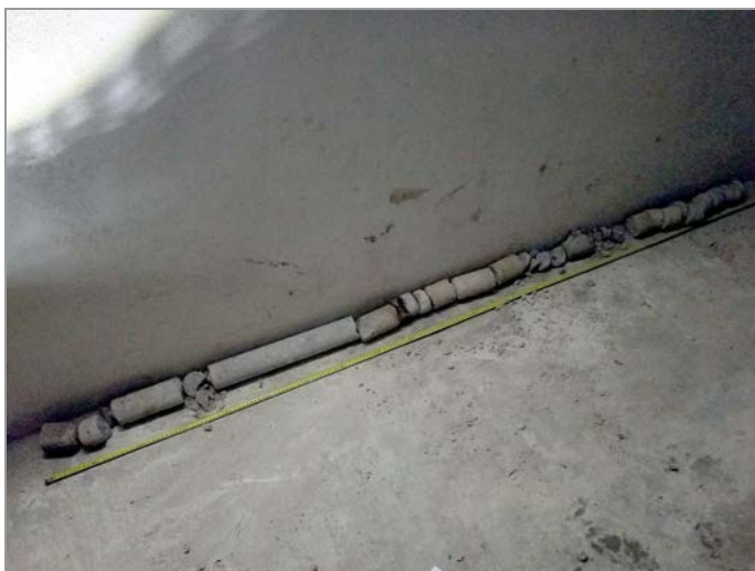
foto 17, 18: Pohled na jádro vrtané sondy S-3 a detail jeho koncové části (základová spára) s rostlími písčítými slínovci (opuky)
