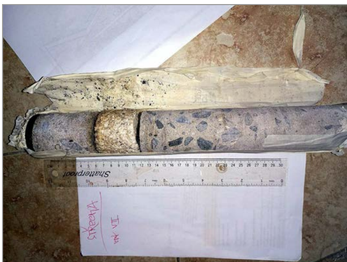
foto 39: Pohled na jádro vrtané sondy V-2
