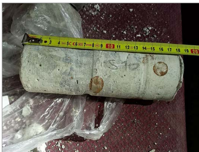
foto 27, 28: Pohled zespodu na místo vrtané sondy S-10 do stropní desky nad 2.NP a detail jádrového vývrtu z desky s výztuží
