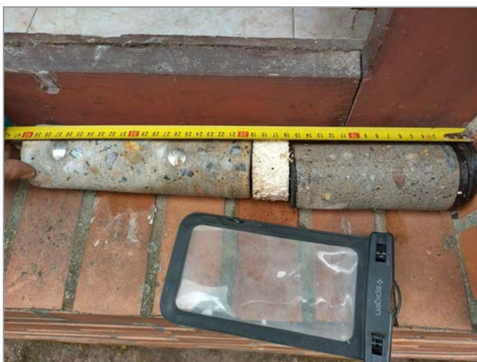
foto 45: Pohled na jádro vrtané sondy V-3
