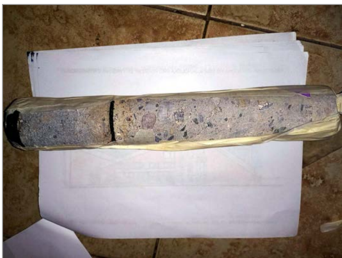
foto 35: Pohled na jádro vrtané sondy V-1
