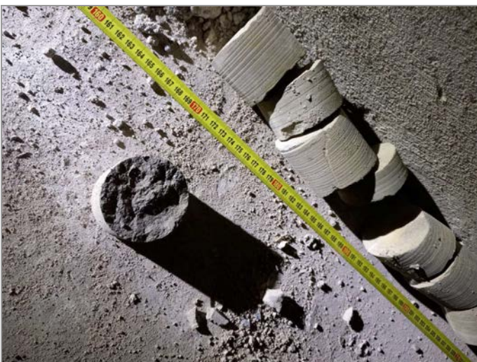
foto 17, 18: Pohled na jádro vrtané sondy S-3 a detail jeho koncové části (základová spára) s rostlími písčítými slínovci (opuky)
