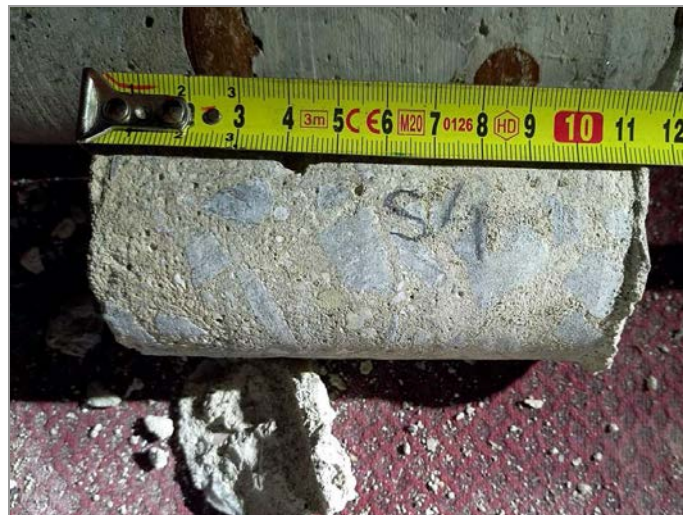
foto 19, 20: Pohled na místo plošné sondy S-4 do stropní desky nad 1.PP a detail jádrového vývrtu z desky
